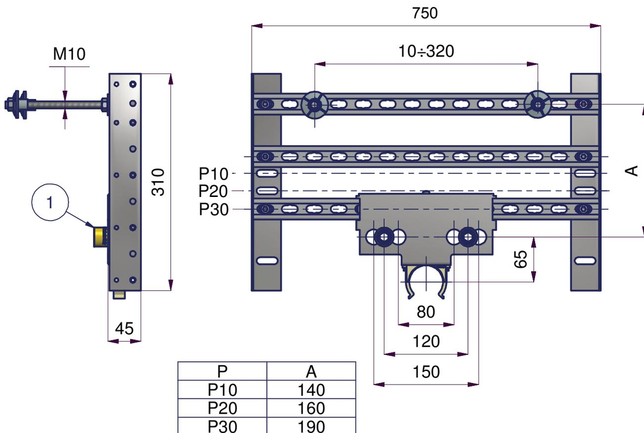
NELLA SCATOLA E' FORNITO COMPLETAMENTE PREMONTATO AD ECCEZIONE DEI DUE TIRANTI M 10
